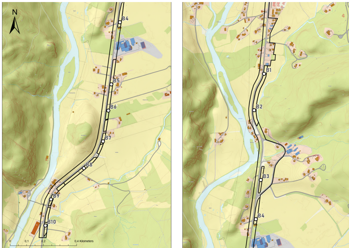
Figur 2-3. Oversikt over borpunktene plassering i tiltaksområdet som går over dyrket mark. Kartgrunnlag: Geodata AS, Kartverket, Geovekst og kommunene.
